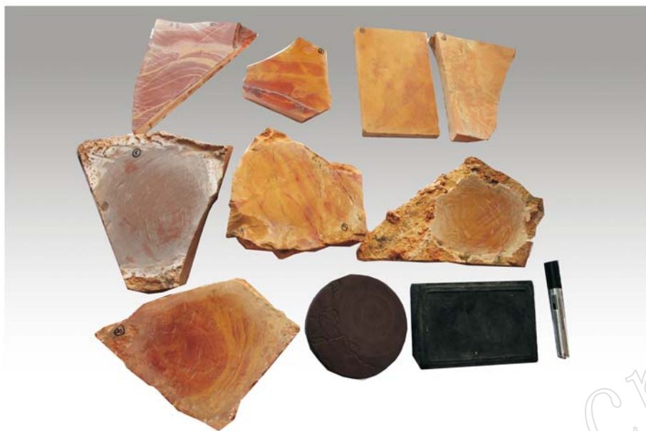
图 1 发墨实验砚石样品照片
