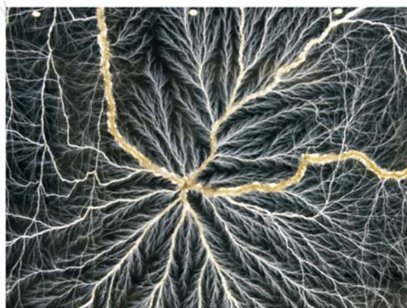
图 2 金辉辐射公司利用电子束辐照技术在有机玻璃中产生的利希滕贝格图形
