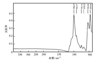
图 3 样品的反射红外光谱
