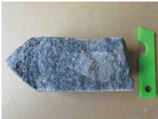
图 2 花岗斑岩手标本和显微镜下照片(电子探针薄片)
