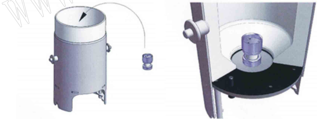
图 5 微样品破碎容器置于常规破碎容器中的位置
