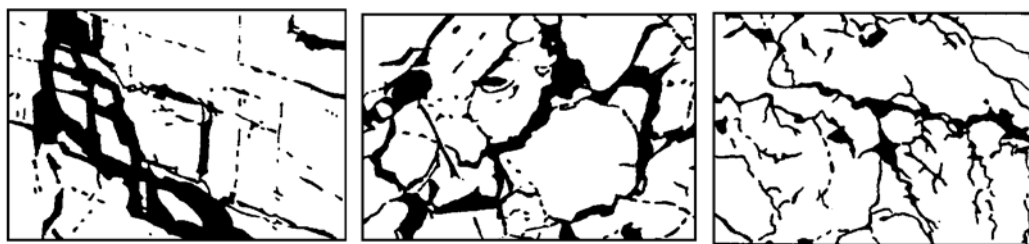
图4 不同组合型式的微型节理及其在花岗石抛光面上形成的暗线、暗斑、暗环
