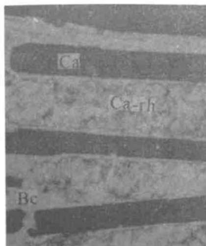
样品号 屈—14 箭状肾硅锰矿 (Ca)分布于蜡硅锰矿(Bc)及钙 菱锰矿(Ca-rh)之中 陕西南部 屈家山锰矿 单偏光 长边 = 4.40mm
