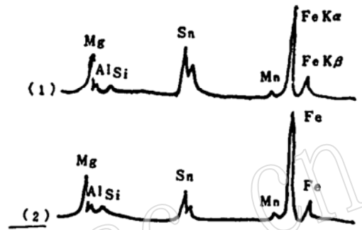
图 2 富锡硼镁铁矿成分能谱图 (两个样, (1)为结构分析样品; (2)为另一单晶颗粒)
