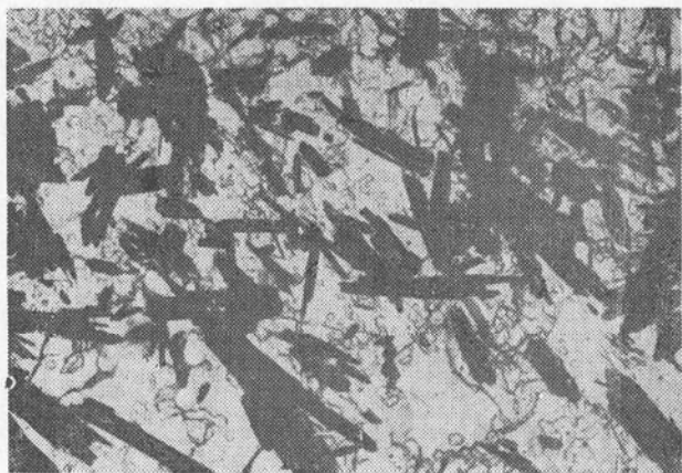
照片1. 富锡硼镁铁矿（黑色）呈柱状，产于白云石大理岩中。（单偏光 ×93） Photo 1. Columnar crystals of tinan ludwigite (black) occurring in dolomitic marble. (parallel polarized ×93)
