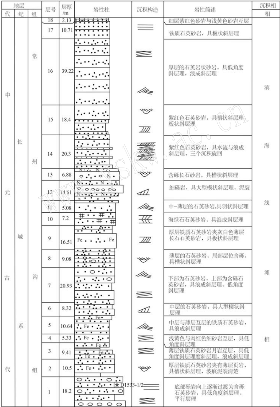
图 2 赞皇杂岩长城系常州沟组综合岩性柱状图与样品位置[据周杰(2016)修改]
