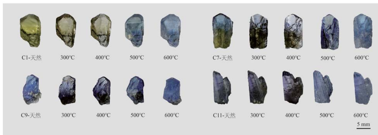
图5 坦桑尼亚黄色及蓝色黝帘石样品在不同温度下的颜色变化
