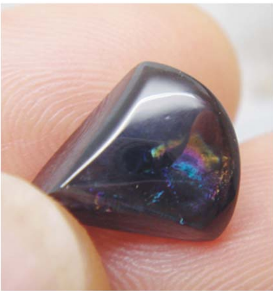
图 2 蓝宝石中微裂隙产生的颜色 Fig. 2 Colors resulting from fractures in Shandong star sapphire
