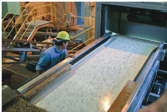
图2 输送带将祖母绿矿石输送至电感耦合摄像探头扫描区域进行选矿(Eric Welch 摄)
