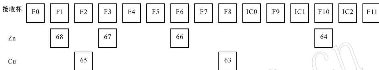
图2 测定 Cu、Zn 同位素组成的接收杯设置示意图
