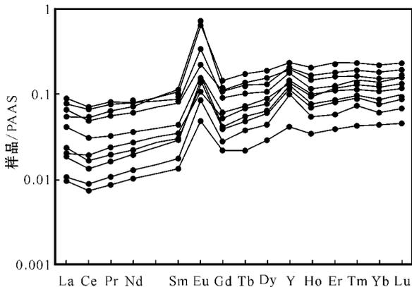
图 1 鞍山-本溪地区 BIF 型铁矿石的 REE 配分图解
