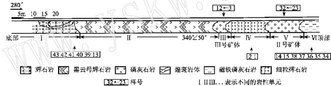
图1 矾山层状岩系470中段5号穿脉和515中段13号穿脉第六韵律单元坑道取样综合示意图
