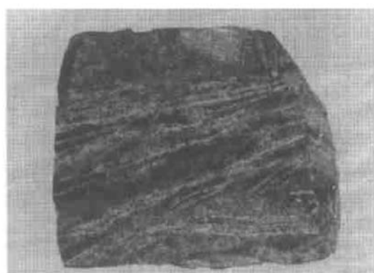
照片8 在角砾硅化岩和粉砂凝灰页岩层位上的含长石石英砂岩,具有缓角度交错层理。
