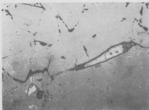
照片1 黄铁矿中 \alpha -汞金银矿(1)-砷黝铜矿 (2)-黄铜矿(3)微脉及自然金(4)“包体” S-2光片 \times 200
