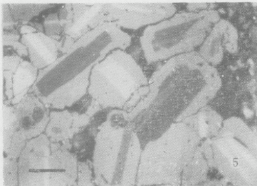
照片 5. 胶黄铁矿矿石中白铁矿变晶的退火双晶结构。安徽铜山 光片 标尺=0.04mm
