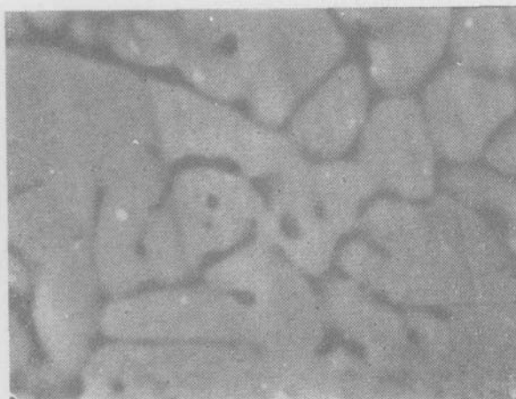
照片7 脑纹结构, SEM, \times 4000
