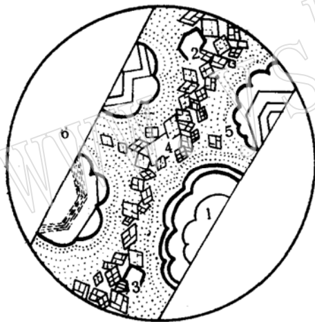
图3 含铀微晶石英矿脉镜下素描图 1.早期闪锌矿；2.晚期闪锌矿；3.晚期方铅矿； 4.铁白云石、方解石；5.沥青铀矿（黑色小点）、 微晶石英（白色）；6.石英正长岩 光薄片 ×25 Fig.3 Sketch in microscope for the vein of uranium-bearing microquartz
