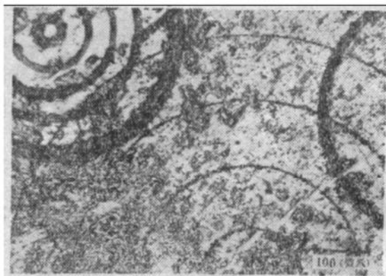
照片2 MM-1型显微刻样器在蛇纹岩表面刻划的标记
