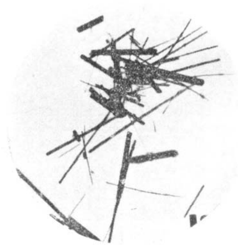
照片 4 热液法合成的硼镁铁矿针状和柱状晶体 (油浸制片, 单偏光, \times 160 )
