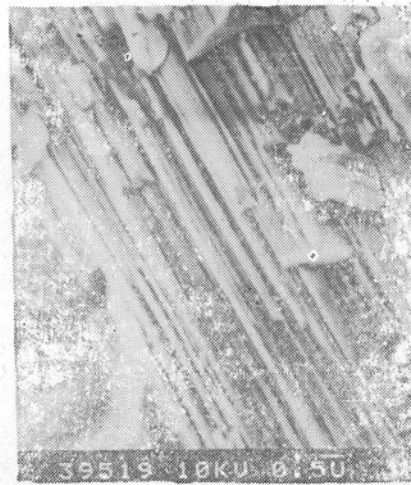
照片 2. 软玉化透闪石的显微结构, \times 6000 (照片1中心部分的放大图象)
